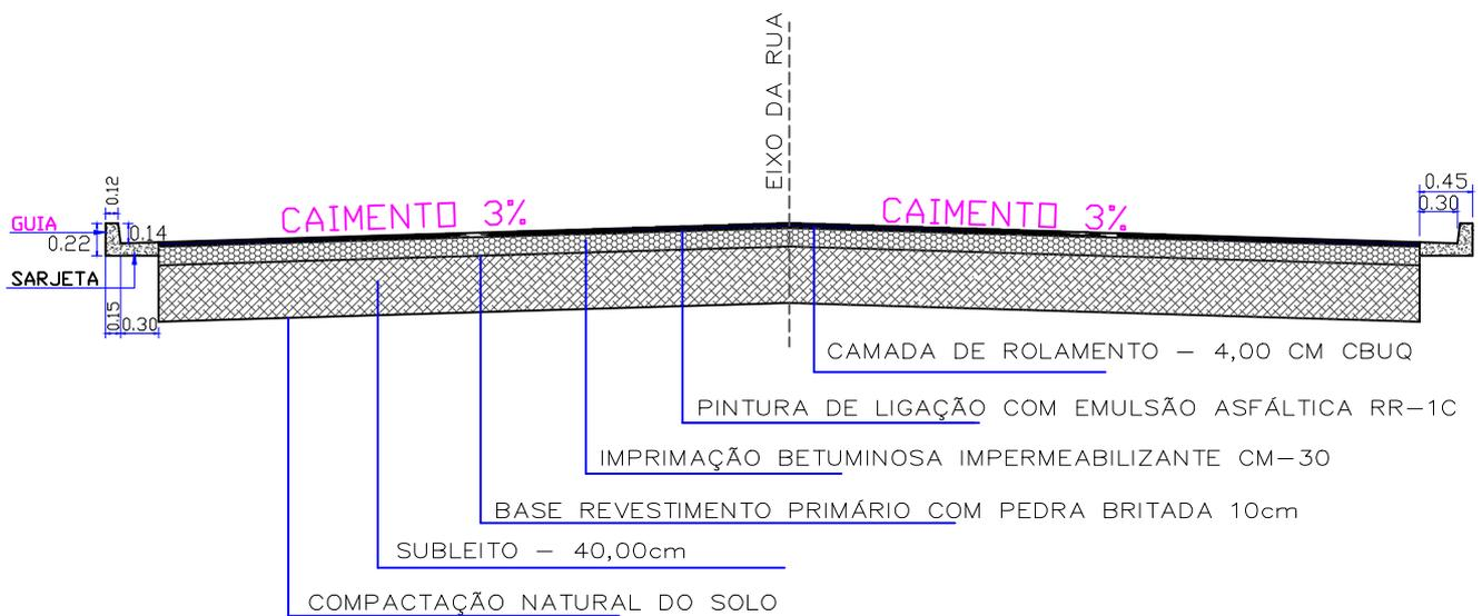
**CORTE TRANSVERSAL - PAVIMENTAÇÃO ASFÁLTICA S/ESC.**
