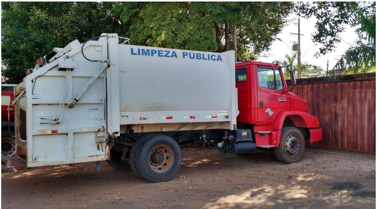
Imagem 31 – Caminhão compactador, utilizado no serviço de coleta convencional.
