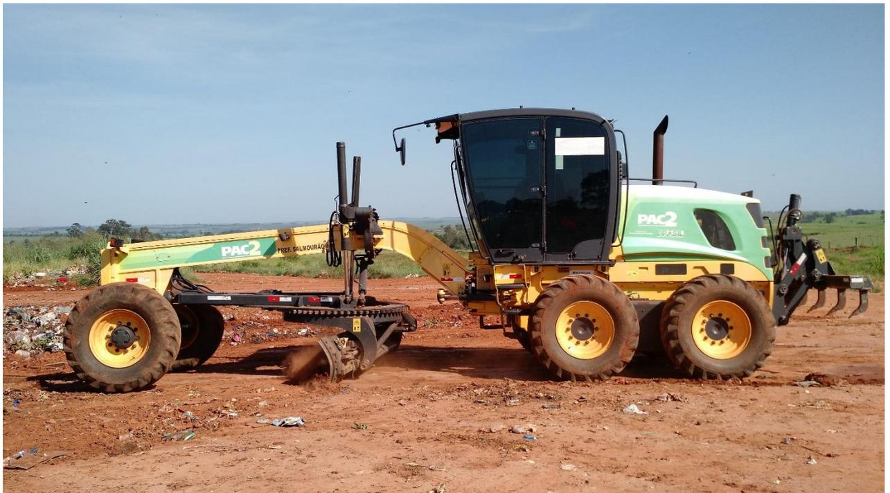
Imagem 37 – Motoniveladora utilizada na manutenção do aterro em valas municipal de Salmourão.
